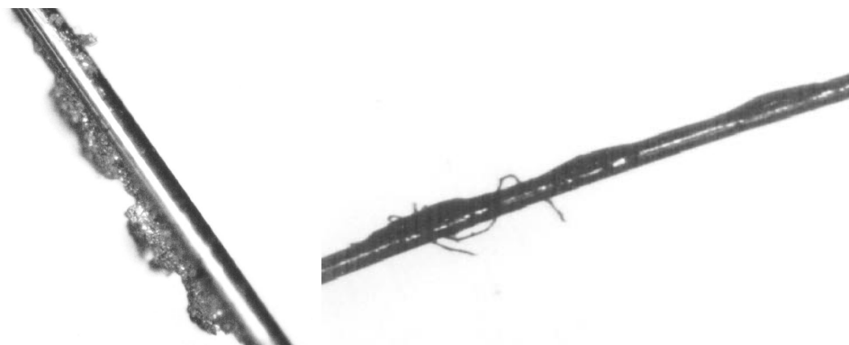
Abbildung 4.1: Auf dem linken Bild ist ein Auslesedraht der CDC mit Silberablagerungen zu sehen. Die Abbildung rechts zeigt einem Draht aus der Driftebene mit verschiedenen Ablagerungen. Die „Verdickungen“ werden von einer siliziumhaltigen Verbindung verursacht [Sch96].
